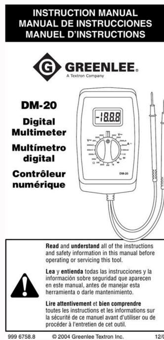
Lire attentivement et bien comprendre toutes les instructions et les informations sur la sécurité de ce manuel avant d'utiliser ou de procéder à l'entretien de cet outil. 999 6758.8 © 2004 Greenlee Textron Inc. 12/04 Description The Greenlee DM-20 Digital Multimeter is a hand-held testing device with the following measurement capabilities: AC and DC voltage, DC current, and resistance.
